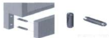
밑판과 사이트 패널의 연결방식(Connection methods between skirting board and sideboard)
