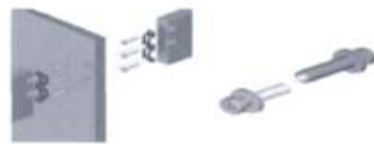
공용판넬과 선반의 연결방식(Connection methods between sideboard and claspboard)
