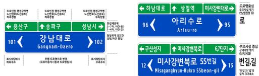
그림 14. 도로규모(대로/로/길)에 따른 도로명표지의 지명의 표기수준 변화 예시
