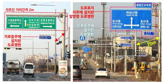
그림 4. 설치위차로 인한 도로표지/도로명판의 판독저하사례
