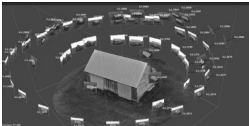
[그림 3] 포토그래메트리를 통한 3D 객체 생성 (출처 : Bitfab)
