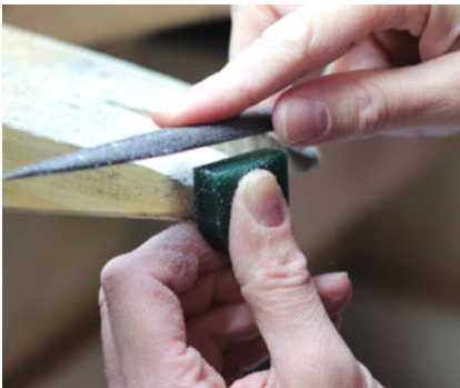
[그림 8] 왁스 카빙(wax carving) 진행 과정
