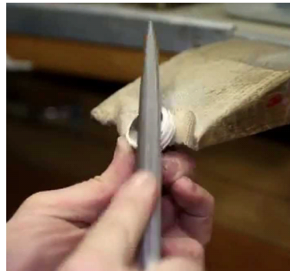
[그림 4] 줄질(filing) 진행 과정
