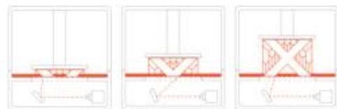
[그림 4] SLA 프린팅 과정
