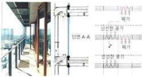
[그림 7] 뒤셀도르프 "Gate to the City"의 복도 커튼월, 단면 및 입면도 (자료: Östler Lieb, Lutz Heusler)
