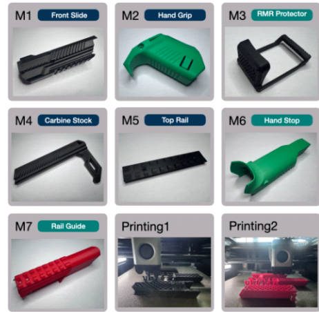
[그림 6] PLA 기반 FDM/FFF 실물 출력물
