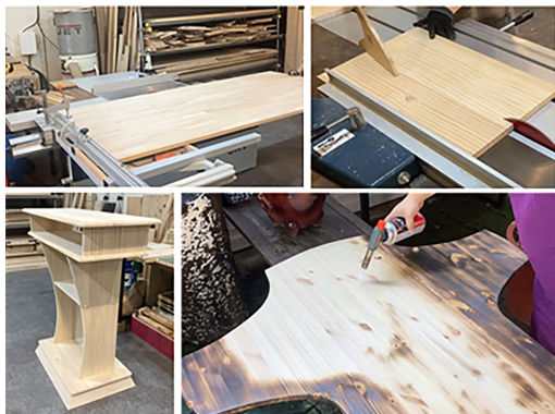
[그림 4] 가공, 가조립 및 탄화 표면처리 과정
